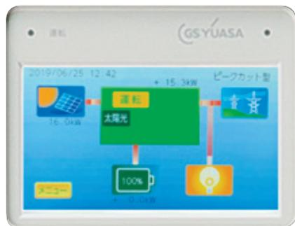
運転モード設定、充放電時刻・曜日設定、各種状態表示、異常履歴の確認が可能です。タッチパネルによる直感的な操作が可能です。
